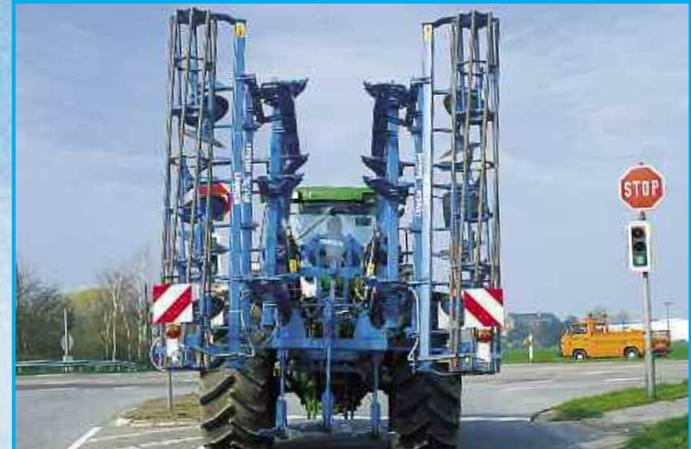
Для транспортировки по дорогам секции агрегата легко и быстро складываются при помощи гидравлики.
