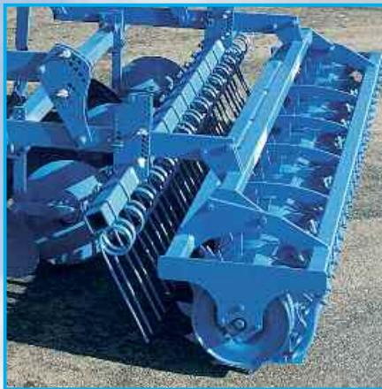
При тяжелых условиях эксплуатации агрегата Смарагд 9 можно применять вместо трубчато-ребристого и сдвоенного катка также зубчатый уплотняющий каток диаметром 500 мм. Благодаря простому регулированию скребок гарантируется отличное прохождение по мокрым и твердым почвам без прилипания земли.
