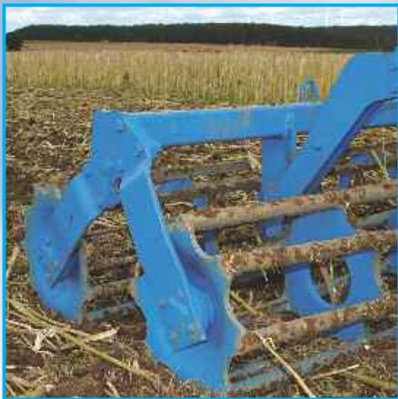
Сдвоенный каток с последовательным расположением катков для агрегата Смарагд 9 в качестве специального оборудования состоит из трубчато-ребристого и планчанто-ребристого катков диаметрами 400 мм каждый. Благодаря интенсивному крошению почвы обеспечивается лучшая всхожесть семян зерновых, которые выпали при уборке урожая, и сорняков. Дополнительно обеспечивается хорошее обратное уплотнение почвы.
