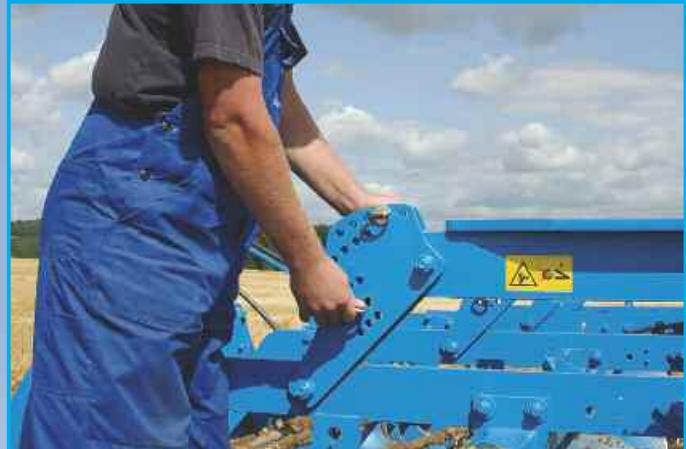
Двухбалочная рама в соединении с параллельно закрепленными вогнутыми дисками и трубчато-ребристым катком позволяет легко регулировать глубину обработки и обеспечивает точное заглубление агрегата Смарагд.
