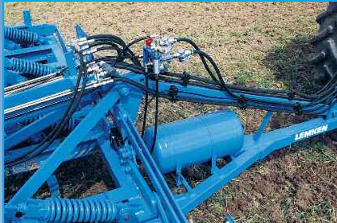
Благодаря универсальной гидравлической системе возможно агрегатирование комбинации с тракторами любой модификации. Для обслуживания комбинации Смарагд и Солитэр предусмотрено четыре цилиндра двойного действия и один цилиндр одинарного действия. При использовании гидрораспределителя 6/2 один цилиндр двойного действия не задействуется. С помощью электронного блока управления все функции комбинации Смарагд – Солитэр можно выполнять с помощью двух цилиндров двойного действия.
