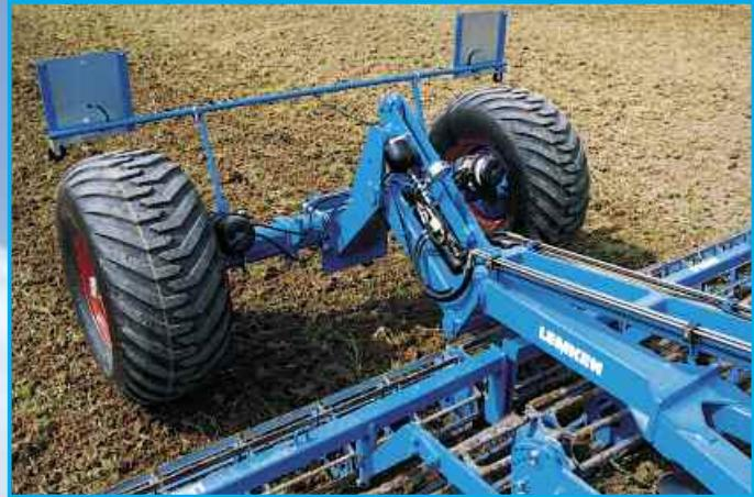
Высокую степень надежности при работе и транспортировке обеспечивает шасси с хорошо отрегулированной пневматической системой тормозов и крупногабаритными колесами при максимальной ширине колеи (рассчитано на 8 т общего веса и 50 км/ч). Это обеспечивает минимальное давление на почву и безопасную транспортировку по дорогам в том числе и при агрегатировании универсального агрегата Смарагд с навесной пневматической сеялкой Солитэр.
