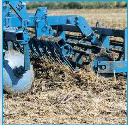
Универсальный агрегат Смаагд может использоваться также для эффективного заделывания промежуточных культур. Агрегат выполняет эту работу с превосходным качеством, без забивания рабочих органов (даже при высоком стебле-стое растений). Зеленая масса оптимально перемешивается с почвой и быстро разлагается.
