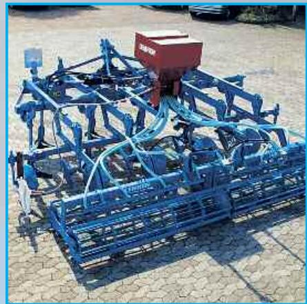
Для непосредственного высева сидератов во время обработки почвы агрегат Смарагд можно комбинировать с соответствующими посевными устройствами. Посевной материал вносится через шланги в режиме разбросного посева. Каток обеспечивает хорошее крошение и повторное уплотнение почвы, благодаря этому промежуточные культуры очень быстро и равномерно всходят.
