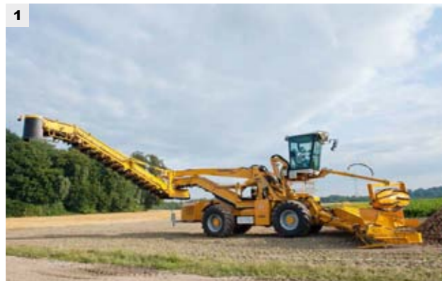
Cleanliner Mega (1) оборудован V-образным приемным устройством шириной 10 м и перегрузочным механизмом длиной 15 м. Опционально можно заказать приемное устройство с разделителем буртов (2). В режиме передвижения по дорогам вальцовые столы складываются за опускающейся кабиной, что обеспечивает хороший обзор.
