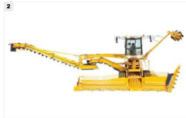
Cleanliner Mega (1) оборудован V-образным приемным устройством шириной 10 м и перегрузочным механизмом длиной 15 м. Опционально можно заказать приемное устройство с разделителем буртов (2). В режиме передвижения по дорогам вальцовые столы складываются за опускающейся кабиной, что обеспечивает хороший обзор.
