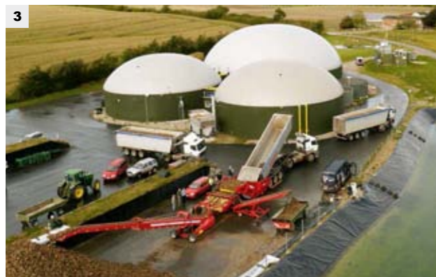
Оптимальное решение в области техники для подготовки свеклы в целях получения биогаза представляют собой BeetLoader (3) и BeetBeater (4). Разработка такой техники стала основой для конкурентноспособной ценовой структуры, которая поставила свеклу на второе место после кукурузы в списке овощей, используемых в целях получения биогаза.
