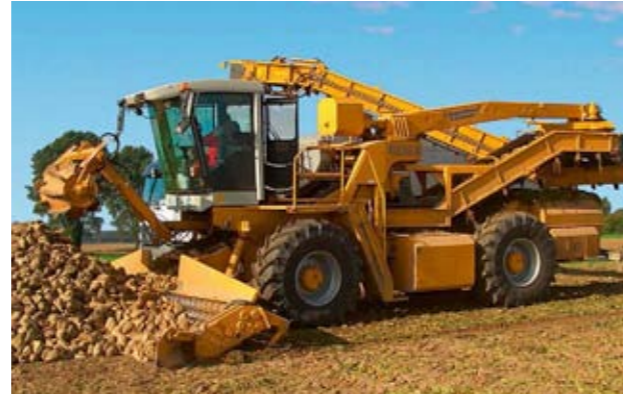
Cleanliner Classic с шириной приемного устройства 8 м и шириной перегрузки 13 м является выгодным в ценовом отношении вариантом очистительно-погрузочной техники.
